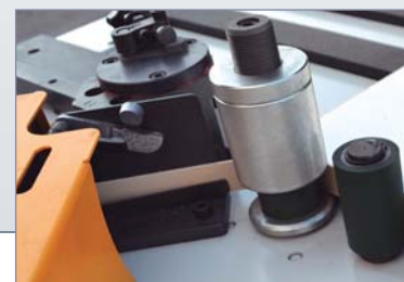
Calderín de cola Glue tank Bac à colle
